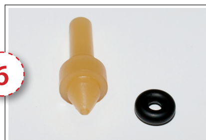
Důkladně vyčistěte gumový O-kroužek a hrot kuželového ventilu
