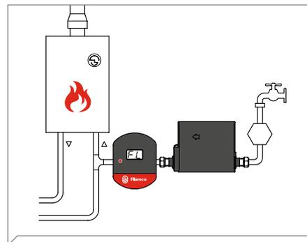
Flexcon PA AutoFill s aplikací. Servisní technik nainstaluje plně automatickou jednotku. K doplňování dochází automaticky. Jednotka AutoFill obdrží signál vždy, když technologie Flexcon PA vyhodnotí, že je nutné systém doplnit. Zákazník nemusí dělat vůbec nic.
