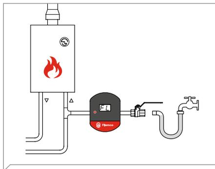
Flexcon PA s aplikací. Servisní technik připojí zařízení k jednotce ústředního vytápění. Bude-li to nutné, zákazník doplní systém připojením hadice k ústřednímu vytápění.
