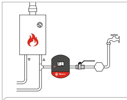
Flexcon PA s aplikací a trvalým připojením k vodovodnímu potrubí. Servisní technik nainstaluje zařízení na přípojku studené vody společně s kulovým kohoutem nebo ventilem a zpětnou klapkou. Pro zahájení doplňování stačí pouze, aby zákazník otevřel ventil.
