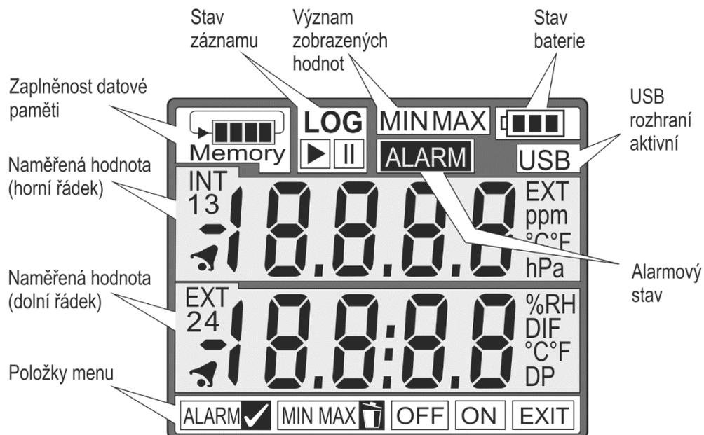
**Zaplněnost datové paměti** – poskytuje informaci o aktuálním stavu volného místa v datové paměti. Pokud nápis *Memory* bliká, znamená to, že byl překročen nastavený limit zaplněnosti paměti. Tento limit se nastavuje v konfiguraci přístroje a lze mu přiřadit různé akce (optická a akustická signalizace).
